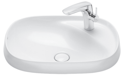
BEYOND Medidas: 585 x 450 x 160 mm. Fineceramic®. Se suministra con 1 orificio del lado derecho. Incluye desagüe universal con tapón cerámico Ø 72 mm. No incluye grifería. A3270B6000
